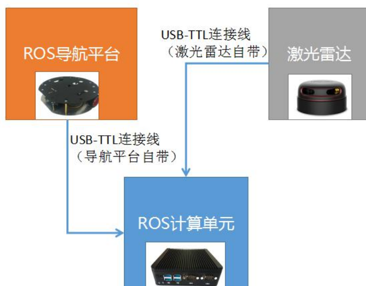
图：ROS 系统导航硬件基本框图
